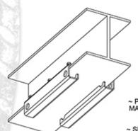
~ PLACE THE PULL-UP BAR MAIN SUPPORTS ON EACH SIDE OF THE I-BEAM
